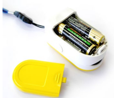
Εικ./Fig.3. Τοποθέτηση Μπαταριών/Batteries Installation
