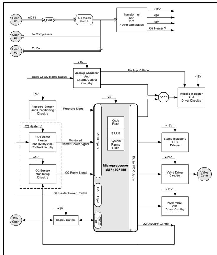
**FIGURE 4-2: EVERFLO PCA CONTROLLER BLOCK DIAGRAM**
